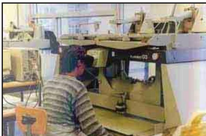
**Figura 3.2** – Restituidor analógico (Fonte: *Universitat Politècnica de València*).
