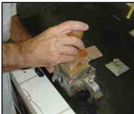
**Figura 5.6** – Transferência do solo para a caixa bi-partida.
